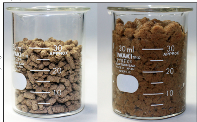
写真-1 (左) 浸水前 (右) 浸水 5 分後
