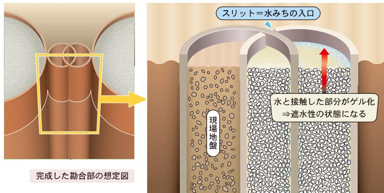
T57全体が継手内で直径14cmの大きな止水壁となって、鋼管矢板の背面から前面への水みちを遮断して止水効果を発揮します。
