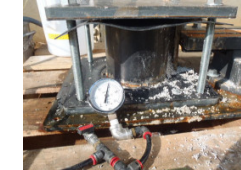
Photo.16 0.30MPaにおける漏水状況
