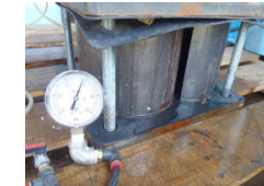
Photo.27 0.30MPaにおける漏水状況
